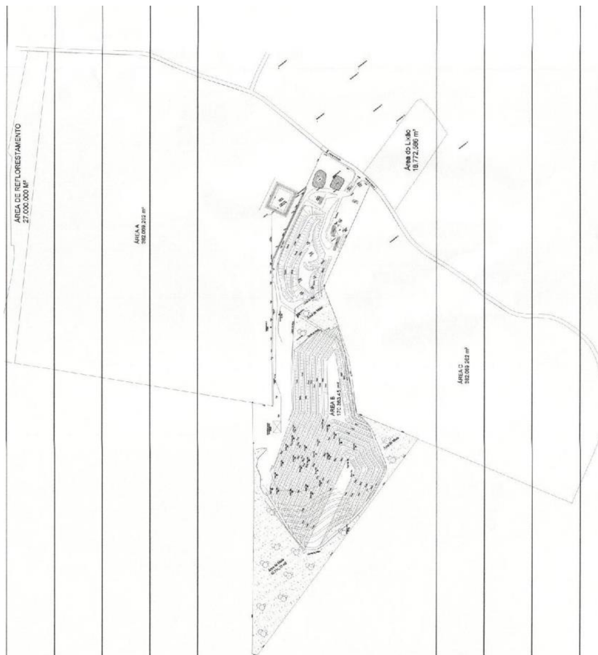
Figura 49 – Planta do Aterro Sanitário Dois Arcos.
